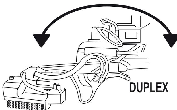
Rampetta anteriore al trattore con sfilo idraulico, pistone alzata e pistone inclinazione, comandi elettrici, funzionante con la pompa del trattore (1 leva doppio effetto olio.)
